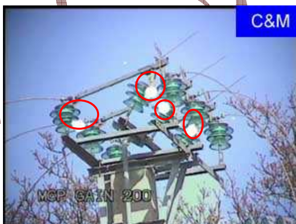
شکل - ۸: تصاویر کرونای ناشی از عیب موجود بر روی مقره های شیشه ای ۲۰ کیلوولت
