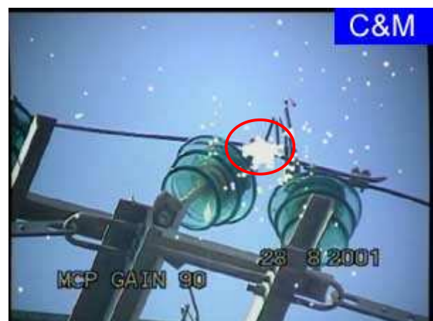
شکل - ۸: تصاویر کرونای ناشی از عیب موجود بر روی مقره های شیشه ای ۲۰ کیلوولت
