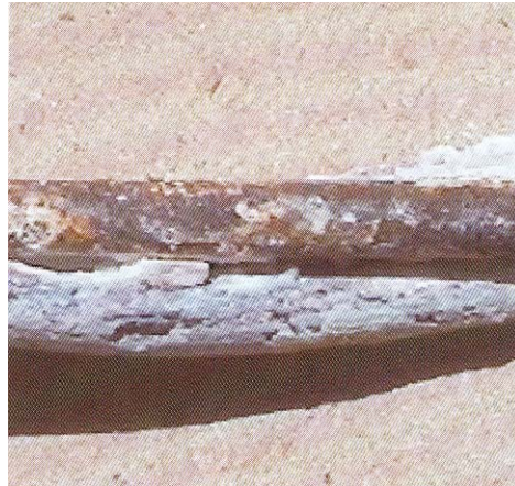
شکل - ۷: نابودی کامل پوشش آلومینیومی هادی و مختل شدن عملکرد برق رسانی
